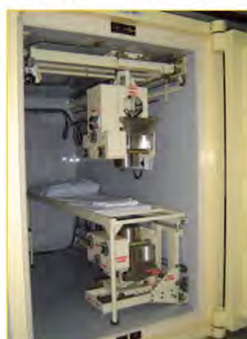
鉄室 壁厚鉄20cm、 鉛3mm、プラスチック5mm
