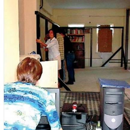
Les chercheurs de l'université de Bogazici procèdent à des simulations sismiques afin de déterminer la résistance au choc et le comportement de certains objets et matériaux courants et d'identifier les mesures d'ARNS les plus efficaces.
