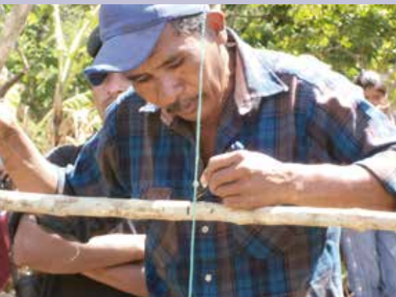
Don Jose Ramón Rivera calibrando el nivel tipo A en la escuela de campo sobre café agroecológico en la comunidad de La Fuente. Fuente: Cruz Roja Nicaragüense
