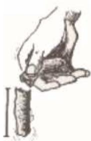
*Selon la longueur du morceau qui tombe lorsque l'on fait glisser un cigare de terre d'environ 3cm de diamètre et 20cm de long (fabriqué en enlevant les particules de plus de 5mm de diamètre), on peut estimer l'argilosité de la terre : si la longueur est inférieure à 7cm, la terre est plutôt sableuse et a priori adaptée à la production de BTC, si la longueur est comprise entre 7 et 15cm, la terre est plutôt argileuse et adaptée à la production d'adobes.*
