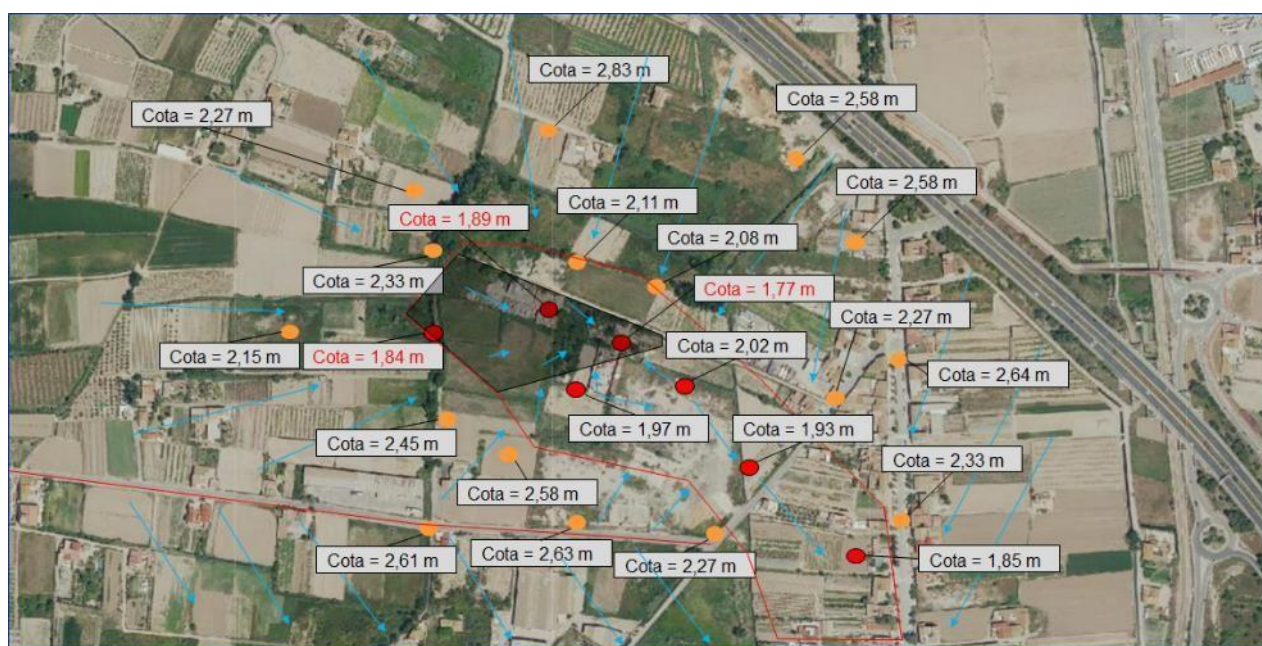
Figura 10: Cotas del terreno de diferentes puntos del área analizada. Fuente: Modelo digital del terreno del IGN
